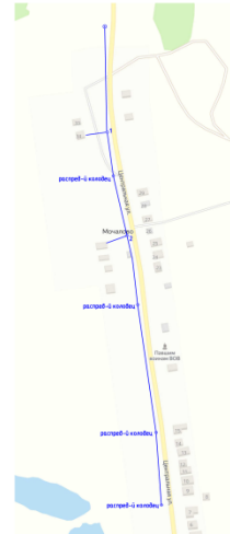
Схема водоснабжения д. Турбенево Масштаб 1:50000
